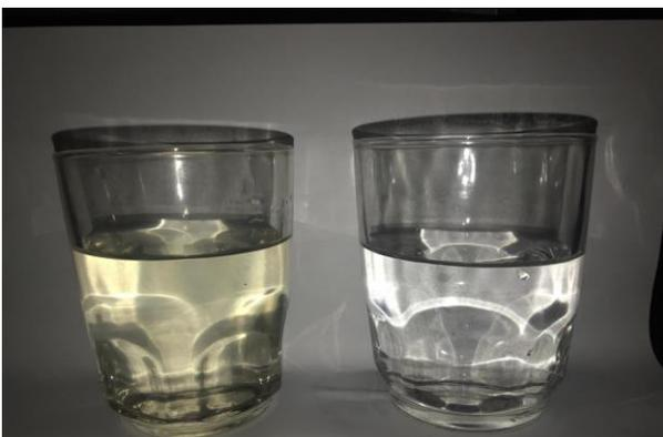
**Gambar 4.** Perubahan fisik air berupa warna sebelum dan sesudah dimasukkan di alat penyaring *Reverse Osmosis*
